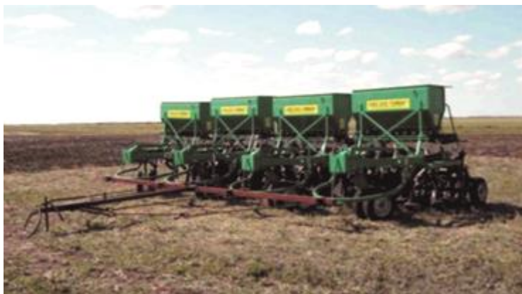
Рис. П. 2.13. Посевной агрегат из четырех сеялок-культиваторов СКС-210 «Омка» (ООО «Омскагроптехсервис», г. Омск)
