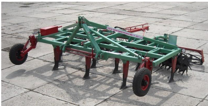
Рис. П. 2.12. Культиватор-плоскорез универсальный КПУ-3,6 (ООО «Буинский машиностроительный завод», Республика Татарстан)
